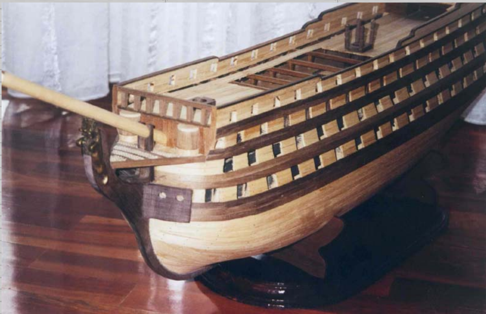
23. Colocados los beques de proa y los apóstoles del baupres según futuro plano de proa.
