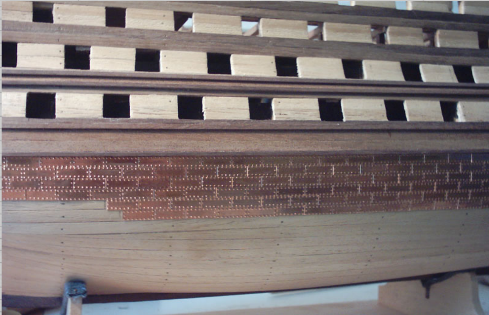
29. Detalle del casco con los refuerzos y el inicio del aplacado de cobre.
