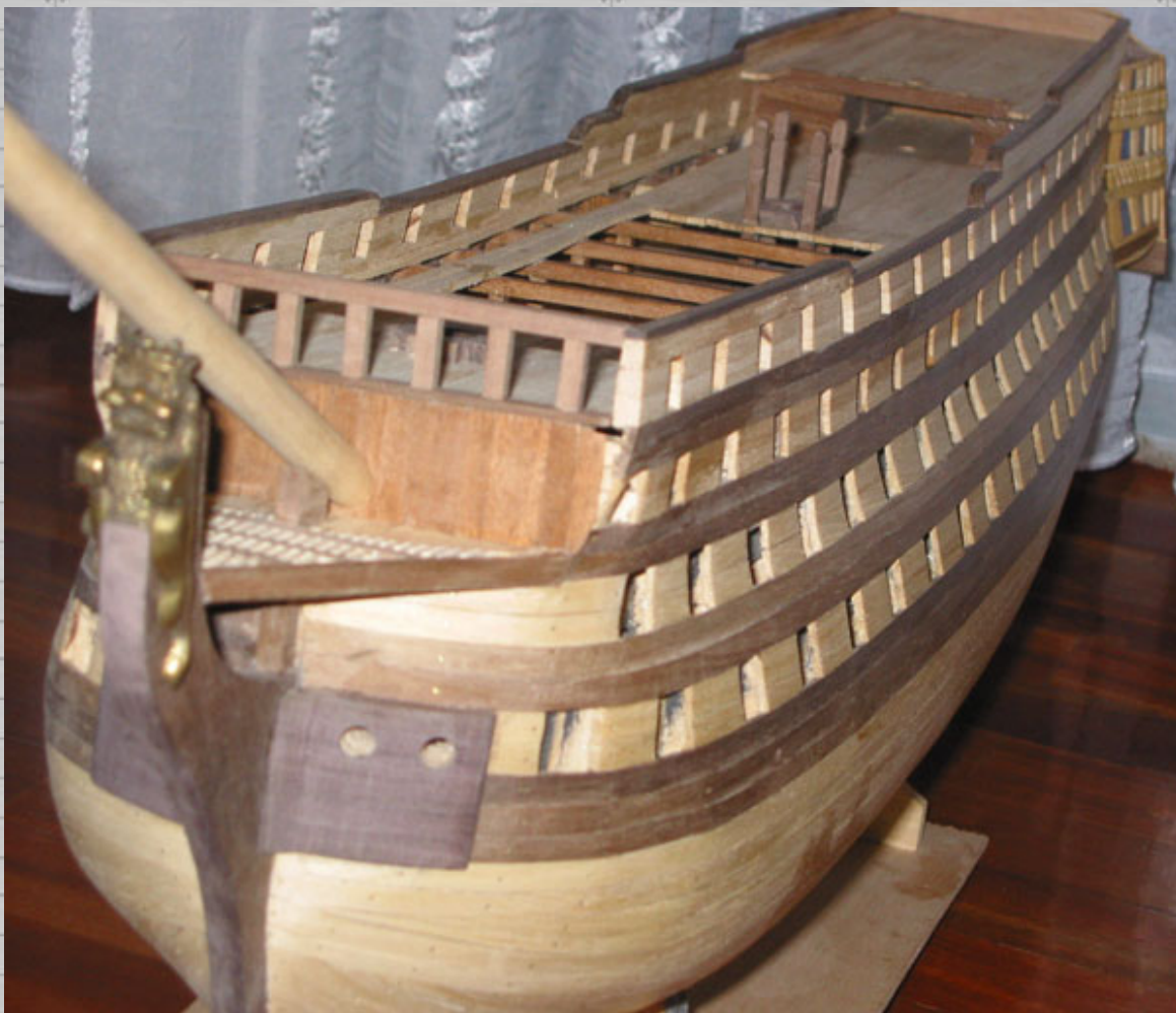
23. Colocados los beques de proa y los apóstoles del baupres según futuro plano de proa.
