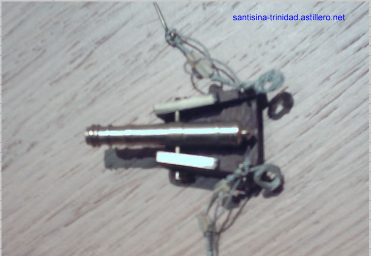
40. Un cañón con su aparejo y los cáncamos que lo anclan al suelo.
